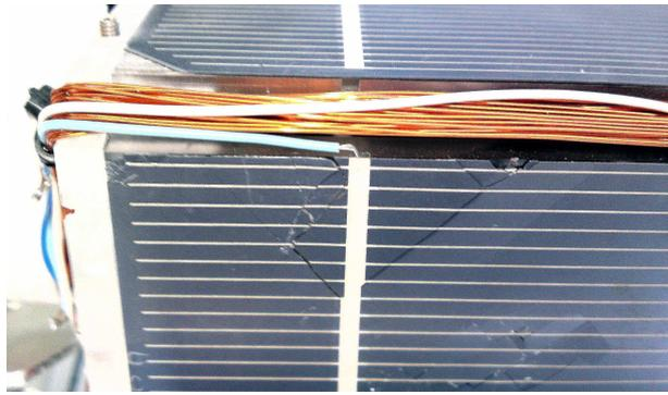
Abbildung 55: Solarzellenbruch
